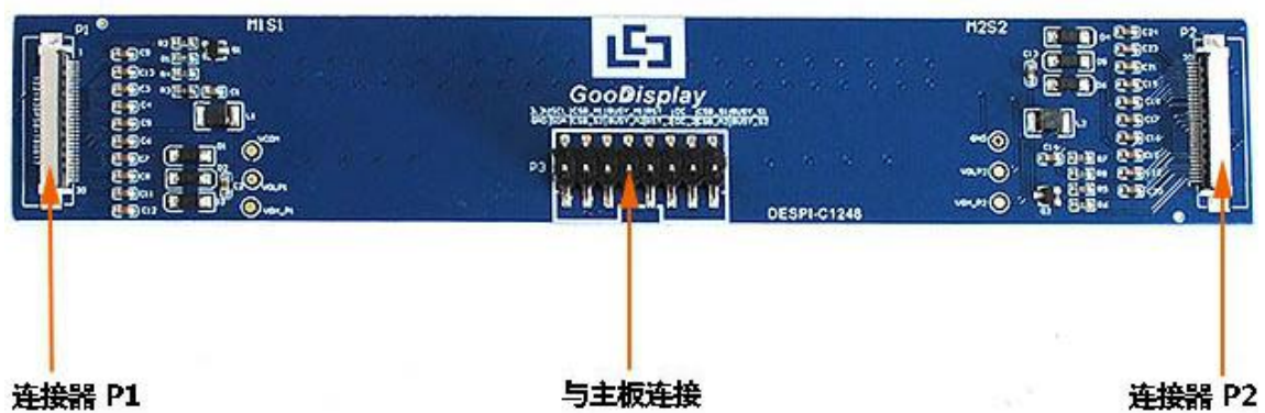
图 2 DESPI-C1248 转接板功能图
