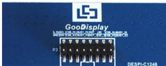
图 6 转接板连接器安装位置 (排针 P3)
