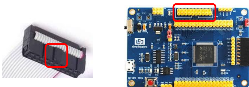
图 11 仿真器排线接口凸起及JTAG接口缺口
