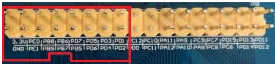
图 5 主板连接器安装位置 (排针 P8)
